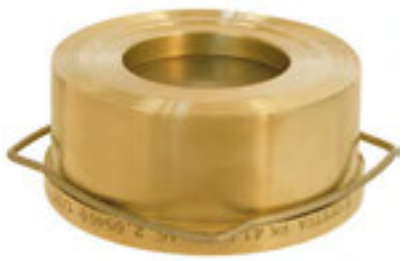
RK 41 螺旋定心 PN 6 到 PN 16, 阀体材料特殊黄铜, 阀瓣采用奥氏体钢
