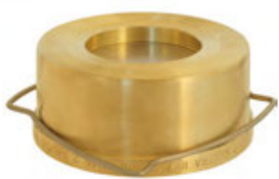
RK 71 螺旋定心 PN 6 到PN 16, 阀体材料热压黄铜, 阀瓣采用奥氏体钢
