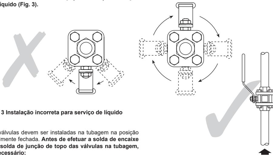
**Fig. 3 Instalação incorreta para serviço de líquido**
