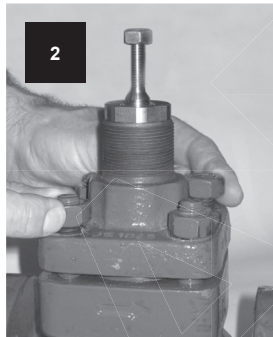
Aperte as porcas ou os parafusos do castelo à mão em pares opostos.
