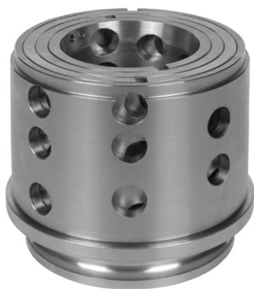
Położenie otworów dla charakterystyki stałoprocentowej
