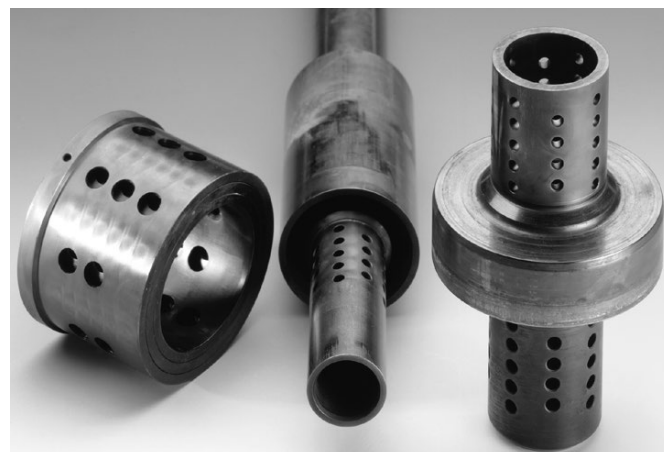
Części wewnętrzne zaworu regulacji minimalnego przepływu ZK 213, DN 100 po 13 latach pracy p_1 = 374 bar, p_2 = 11 bar, T = 172 °C, m = 35 kg/s
