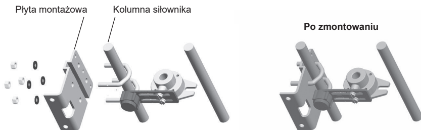
Rys. 29 Montaż siłownika na kolumnach
