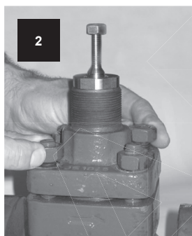
Palcami dokręcać równomiernie parami przeciwległe nakrętki
