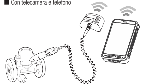
Controllo dello scaricatore di condensa
