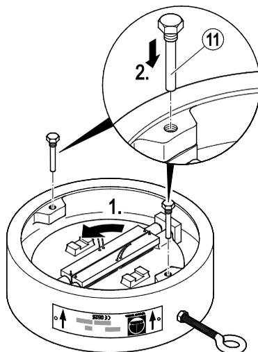
La coppia di serraggio per le viti (11) dipende dal materiale delle viti e del corpo come pure dalla dimensione dell'apparecchio. Per i valori delle coppie di serraggio vedere la tabella a seguito.
