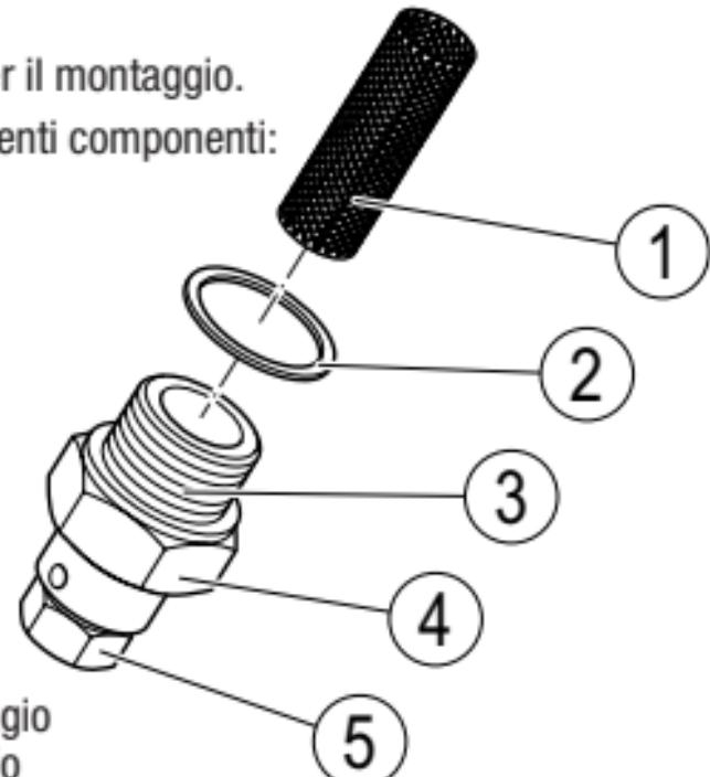
Tutti i componenti della valvola di drenaggio sono in acciaio inox.
