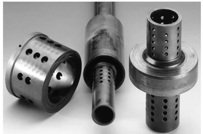
Pièces internes d'un robinet de réglage de débit minimal ZK 213, DN 100 après 13 ans de service
