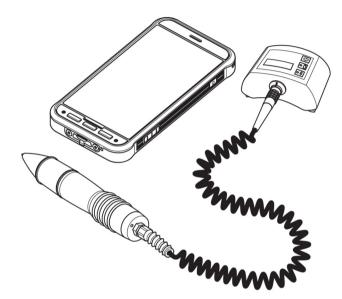
Dispositivo de comprobación para purgadores de condensado
