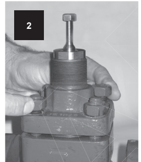
Apriete con los dedos las tuercas o tornillos opuestos del capó uniformemente de dos en dos.
