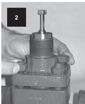
Apretar a mano las tuercas opuestas de la tapa o los tornillos en parejas.
