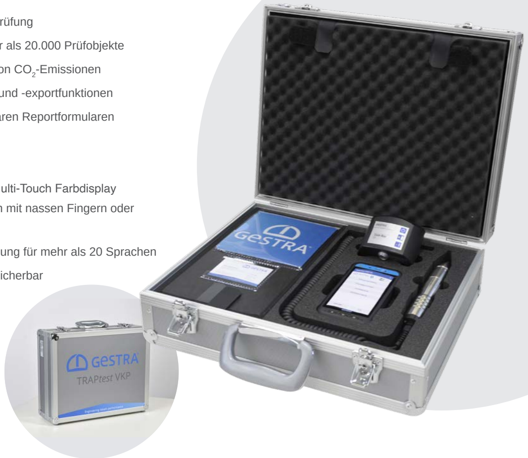
VKP 42 (Ex): Datensammler, Messwert- aufnehmer und Com-Box
