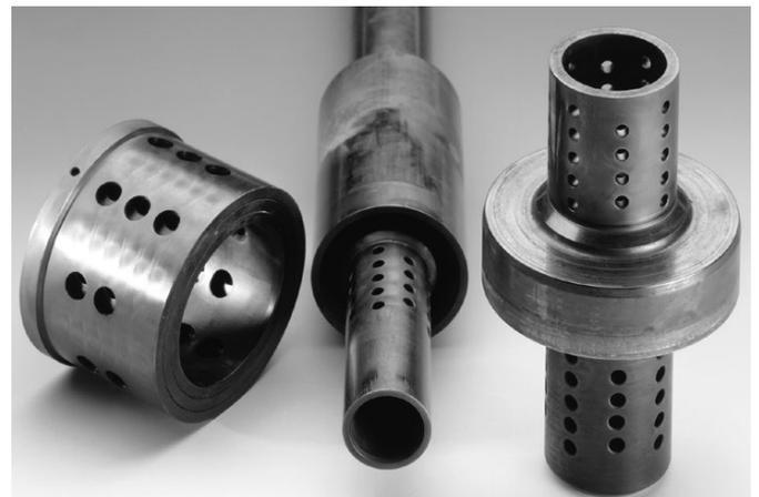
Innenteile eines Mindestmengenregelventils ZK 213, DN 100 nach 13 Jahren Betrieb
