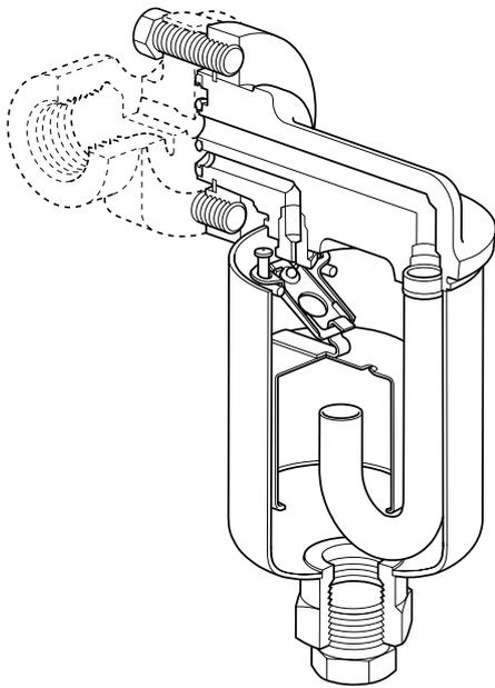
Glockenschwimmer-Kondensatableiter für die Verwendung mit Universal-Anschlusseinheiten (PC)
