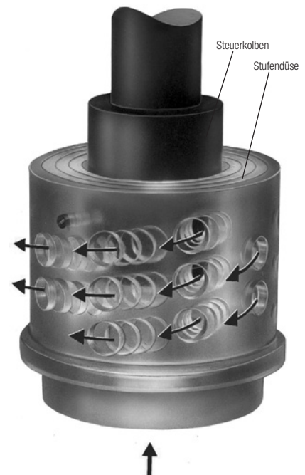
Durchströmung ZK 29 - Radialstufendüse
