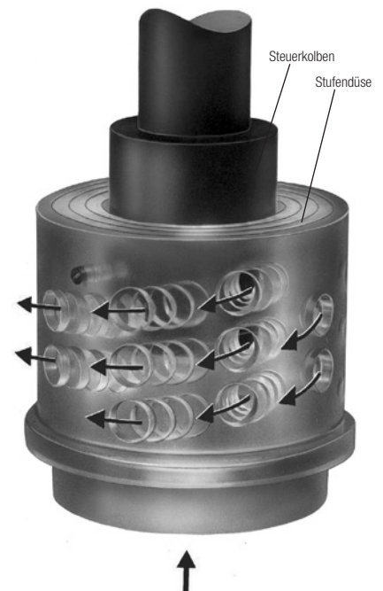
Durchströmung ZK 29 - Radialstufendüse
