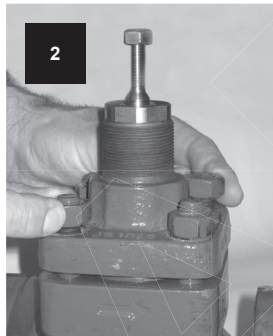
Gegenüberliegende Gehäusemuttern wechselseitig gleichmäßig handfest anziehen.
