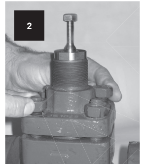
Gegenüberliegende Gehäusemuttern wechselseitig gleichmäßig handfest anziehen.
