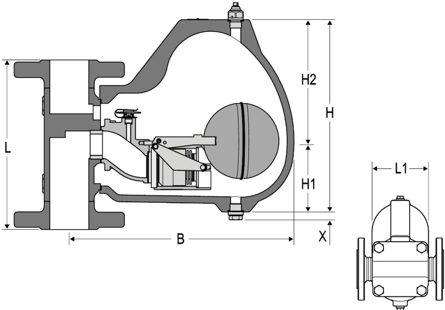
**UNA 45 MAX, UNA 46 MAX und UNA 46A MAX mit Flansch EN 1092-1 PN 10–40**
