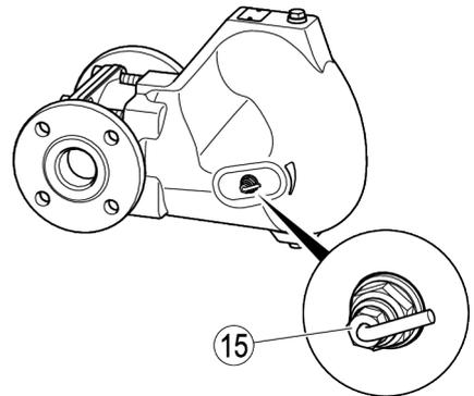
Wenn Sie die Stopfbuchspackung auf diese Weise nicht abdichten können, müssen Sie die vollständige Hand-Anlüftvorrichtung ersetzen.
