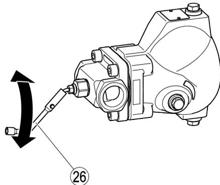
Sie können das Gerät nach Bedarf während des Betriebs mit den GESTRA Ultraschallprüfgeräten VAPOPHONE® oder TRAPTEST® (VKP 40 und VKP 40plus) auf einwandfreie Funktion prüfen.
