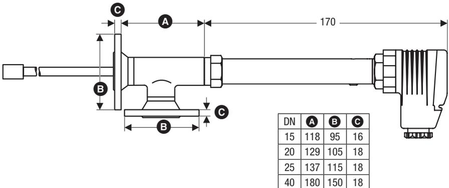
**Fig. 4** LRG 16-4 mit Anschlussstück in T-Form
