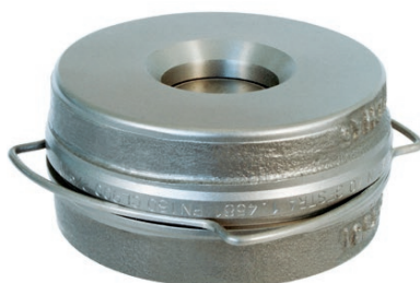
RK 49 com anel de centralização em espiral, versão de alta pressão, PN 63/100/160, DN 15 a 100. Material: aço fundido austenítico resistente ao calor/aço fundido resistente ao calor.
