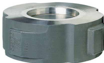
RK 86 e 86A com centralização universal patenteada. Como aparelho padrão cabe entre os flanges PN 6-40, classe 150/300 como também entre o flange BS10. Material do corpo: aço inoxidável (RK 86) ou austenítico (RK 86A). Disco da válvula: aço austenítico.
