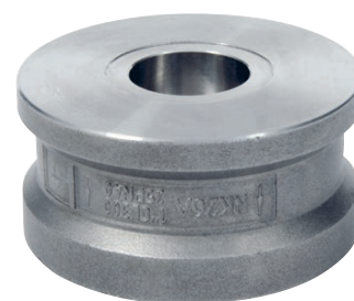
RK 26A com centralização do corpo, PN 10 a 40, DN 15 a 100. Opcionalmente contra flange adequada segundo ASME 150 RF, ASME 300 RF, lingueta ou flange com encaixe macho segundo DIN EN 1092. Material: aço austenítico.
