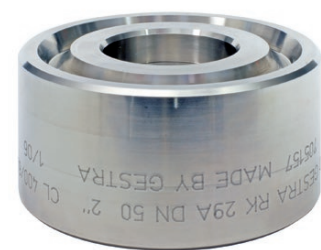
RK 29A com centralização do corpo, PN 63 a 160 (PN 400 a pedido), classe 400 a 1500 (classe 2500 a pedido). Material: aço austenítico.
